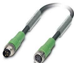
Câble pour capteurs/actionneurs, 4-pôles, PUR exempt d'halogène, gris-noir RAL 7021, connecteur mâle droit M8, détrompage: A, sur Connecteur femelle droit M8, longueur de câble: 1,5 m
