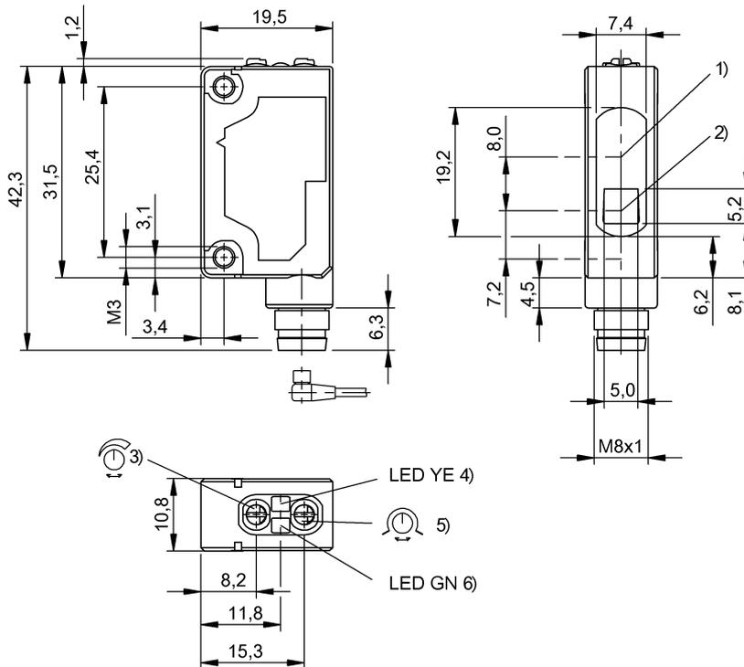
1) Axe optique récepteur, 2) Axe optique émetteur, 3) Sensibilité, 4) Fonction de sortie, 5) Détection claire/sombre, 6) Stabilité
