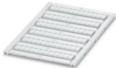
Repères pour blocs de jonction, à commander : sous forme de planche, blanc, impression selon les indications du client, type de montage: encliquetage dans la rainure de repérage plate, pour bloc de jonction au pas de : 5,2 mm, surface utile: 4,4 x 4,7 mm, Nombre d'étiquettes: 72
