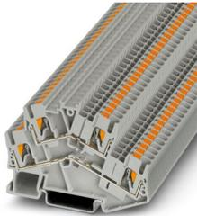
Bloc de jonction à deux étages, tension nominale: 500 V, intensité nominale: 22 A, type de raccordement: Raccordement Push-in, 1er et 2e étage, Section de référence: 2,5 mm<sup>2</sup>, section : 0,14 mm<sup>2</sup> - 4 mm<sup>2</sup>, type de montage: NS 35/7,5, NS 35/15, coloris: gris
