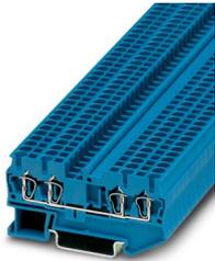
Blocs de jonction simple, tension nominale: 800 V, intensité nominale: 24 A, nombre de connexions: 4, type de raccordement: Raccordement à ressort, Section de référence: 2,5 mm<sup>2</sup>, section : 0,08 mm<sup>2</sup> - 4 mm<sup>2</sup>, type de montage: NS 35/7,5, NS 35/15, coloris: bleu
