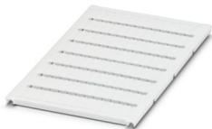
Repères pour blocs de jonction, Planche, blanc, vierge, repérable avec : BLUEMARK ID COLOR, BLUEMARK ID, BLUEMARK CLED, PLOTMARK, CMS-P1-PLOTTER, type de montage: encliquetage, pour bloc de jonction au pas de : 5,2 mm, surface utile: 4,6 x 10,5 mm, Nombre d'étiquettes: 96
