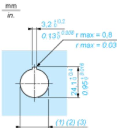
(1) Diamètre sur support ou panneau réalisé
