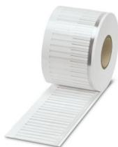
Repère de câble, Rouleau, blanc, vierge, repérable avec : THERMOMARK E. 300 (D)/600 (D), THERMOMARK ROLL 2.0, THERMOMARK ROLL, THERMOMARK ROLL X1, THERMOMARK ROLLMASTER 300/600, THERMOMARK X1.2, type de montage: insertion, plage de diamètre de câble: 1,5 ... 35 mm, surface utile: 23 x 4 mm, Nombre d'étiquettes: 3000
