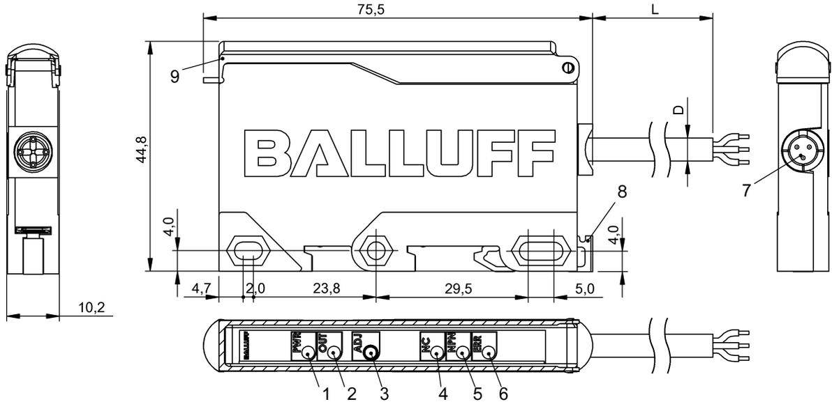
1) LED de tension d'emploi, 2) LED de visualisation d'état, 3) Sn, 4) LED fonction ouverture active, 5) LED étage de commutation NPN actif, 6) LED Erreur, 7) Connexion enfichable capteur, 8) Montage sur profilé chapeau 35 mm, 9) Volet
