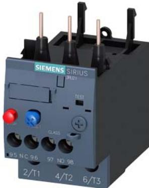
Relais de surcharge 7,0...10 A thermique pour protection des moteurs taille S0, Class 10 Montage sur contacteur circuit principal : à visser circuit auxiliaire : à visser Réarmement automatique/manuel
