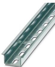
Profilé percé, Conditionnement par 25 unités (50 m), similaire à EN 60715, matériau: Acier, galvanisé, passivation blanche, Profil standard, coloris: blanc
