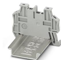
Butée de montage rapide, pour rail DIN NS 35/7,5 ou rail DIN NS 35/15, avec possibilité de repérage et emplacement pour FBS...5, FBS...6, KSS 5, KSS 6, largeur : 5,15 mm, coloris : gris
