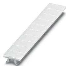
Ruban de repérage ZB, à commander : par bandes, blanc, impression selon les indications du client, type de montage: encliquetage dans la rainure de repérage élevée, pour bloc de jonction au pas de : 6,2 mm, Nombre d'étiquettes: 10
