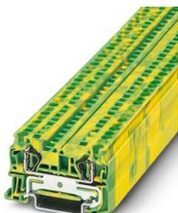
Bloc de jonction à ressort pour conducteur de protection, nombre de connexions: 2, type de raccordement: Raccordement à ressort, 1er étage, section : 0,08 mm<sup>2</sup> - 6 mm<sup>2</sup>, type de montage: NS 35/7,5, NS 35/15, coloris: vert/jaune
