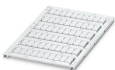
Repères pour blocs de jonction, à commander : sous forme de plaque, blanc, impression selon les indications du client, type de montage: encliquetage dans la rainure de repérage élevée, pour bloc de jonction au pas de : 6,2 mm, Nombre d'étiquettes: 60
