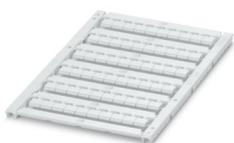
Repères pour blocs de jonction, Plaque, blanc, vierge, repérable avec : TOPMARK NEO, LASER TOPMARK, BLUEMARK ID COLOR, BLUEMARK ID, BLUEMARK CLED, THERMOMARK PRIME, THERMOMARK CARD 2.0, THERMOMARK CARD, type de montage: bloccaggio, pour bloc de jonction au pas de : 6,2 mm, Nombre d'étiquettes: 60, hauteur du champ de texte: 4,7 mm, largeur du champ de texte: 5,4 mm
