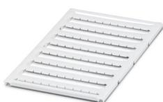
Repères pour blocs de jonction, Plaque, blanc, vierge, repérable avec : BLUEMARK ID COLOR, BLUEMARK ID, BLUEMARK CLED, PLOTMARK, CMS-P1-PLOTTER, type de montage: bloccaggio, pour bloc de jonction au pas de : 6,2 mm, Nombre d'étiquettes: 80, hauteur du champ de texte: 5,1 mm, largeur du champ de texte: 5,6 mm
