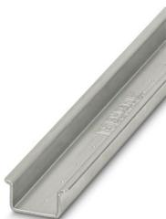
Profilé plein, Conditionnement par 10 unités (20 m), selon EN 60715, matériau: Acier, galvanisé, traité par passivation couche épaisse, Profil standard 2,3 mm, coloris: argenté
