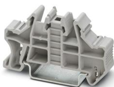
Butée à montage rapide, pour rail DIN NS 35/7,5 ou NS 35/15, avec possibilité de repérage, largeur : 9,5 mm, coloris : gris
