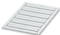
Repères pour blocs de jonction, à commander : sous forme de planche, blanc, impression selon les indications du client, type de montage: encliquetage dans la rainure de repérage plate, pour bloc de jonction au pas de : 6,2 mm, Nombre d'étiquettes: 60
