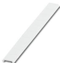
Ruban de repérage ZB, plat, Rubans, blanc, vierge, repérable avec : PLOTMARK, CMS-P1-PLOTTER, type de montage: bloccaggio, pour bloc de jonction au pas de : 6,2 mm, Nombre d'étiquettes: 10, hauteur du champ de texte: 6,15 mm, largeur du champ de texte: 5,15 mm
