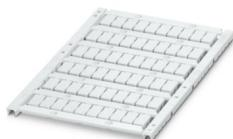
Repères pour blocs de jonction, à commander : sous forme de planche, blanc, impression selon les indications du client, type de montage: encliquetage dans la rainure de repérage élevée, pour bloc de jonction au pas de : 6,2 mm, Nombre d'étiquettes: 60
