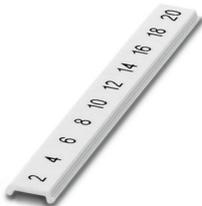
Ruban de repérage ZB, plat, Rubans, blanc, repéré, impression longitudinale: nombres pairs croissants 2 ... 20, 22 ... 40, etc. jusqu'à 82 ... 100, type de montage: bloccaggio, pour bloc de jonction au pas de : 5 mm, Nombre d'étiquettes: 10, hauteur du champ de texte: 5,15 mm, largeur du champ de texte: 5,15 mm
