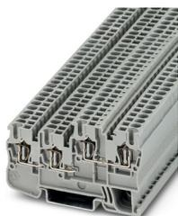
Bloc de jonction pour capteurs/actionneurs, tension nominale: 250 V, intensité nominale: 18 A, nombre de connexions: 4, type de raccordement: Raccordement à ressort, Section de référence: 2,5 mm<sup>2</sup>, section : 0,08 mm<sup>2</sup> - 4 mm<sup>2</sup>, type de montage: NS 35/7,5, NS 35/15, coloris: gris
