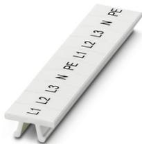
Ruban de repérage ZB, Rubans, blanc, repéré, longitudinal: L1, L2, L3, N, PE, L1, L2, L3, N, PE, type de montage: bloccaggio, pour bloc de jonction au pas de : 5,2 mm, Nombre d'étiquettes: 10, hauteur du champ de texte: 10,5 mm, largeur du champ de texte: 5,15 mm
