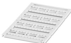
Repères pour blocs de jonction, Planche, blanc, vierge, repérable avec : BLUEMARK ID COLOR, BLUEMARK ID, BLUEMARK CLED, PLOTMARK, CMS-P1-PLOTTER, type de montage: bloccaggio, pour bloc de jonction au pas de : 5,2 mm, Nombre d'étiquettes: 96, hauteur du champ de texte: 5,1 mm, largeur du champ de texte: 4,6 mm
