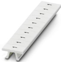
Ruban de repérage ZB, Rubans, blanc, repéré, repérable avec : CMS-P1-PLOTTER, impression longitudinale: chiffres identiques 1 ou 2, etc. jusqu'à 100, type de montage: bloccaggio, pour bloc de jonction au pas de : 5,2 mm, Nombre d'étiquettes: 10, hauteur du champ de texte: 10,5 mm, largeur du champ de texte: 5,15 mm
