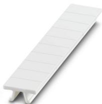
Ruban de repérage ZB, Rubans, blanc, vierge, repérable avec : PLOTMARK, CMS-P1-PLOTTER, type de montage: bloccaggio, pour bloc de jonction au pas de : 5,2 mm, Nombre d'étiquettes: 10, hauteur du champ de texte: 10,5 mm, largeur du champ de texte: 5,1 mm
