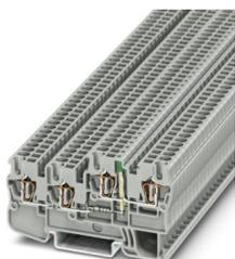
Bloc de jonction pour capteurs/actionneurs, tension nominale: 24 V, intensité nominale: 18 A, nombre de connexions: 4, type de raccordement: Raccordement à ressort, Section de référence: 2,5 mm<sup>2</sup>, section : 0,08 mm<sup>2</sup> - 4 mm<sup>2</sup>, type de montage: NS 35/7,5, NS 35/15, coloris: gris
