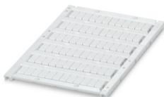
Repères pour blocs de jonction, à commander : sous forme de planche, blanc, impression selon les indications du client, type de montage: encliquetage dans la rainure de repérage élevée, pour bloc de jonction au pas de : 5,2 mm, Nombre d'étiquettes: 72
