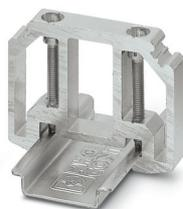
Butée, support terminal des UKH 50 à UKH 240, s'insère sur le profilé NS 35 et se fixe avec 2 vis, largeur : 10 mm, coloris : aluminium
