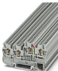
Bloc de jonction pour capteurs/actionneurs, tension nominale: 24 V, intensité nominale: 18 A, nombre de connexions: 4, type de raccordement: Raccordement à ressort, Section de référence: 2,5 mm<sup>2</sup>, section : 0,08 mm<sup>2</sup> - 4 mm<sup>2</sup>, type de montage: NS 35/7,5, NS 35/15, coloris: gris
