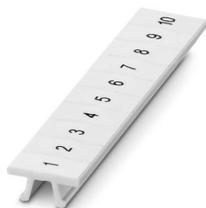
Ruban de repérage ZB, Rubans, blanc, repéré, impression longitudinale: numérotation continue 1 ... 10, 11 ... 20, etc. jusqu'à 491 ... 500, type de montage: bloccaggio, pour bloc de jonction au pas de : 5,2 mm, Nombre d'étiquettes: 10, hauteur du champ de texte: 10,5 mm, largeur du champ de texte: 5,15 mm
