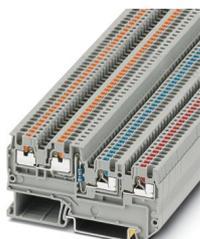
Bloc de jonction pour capteurs/actionneurs, avec résistance de 100 kOhm, tension nominale: 250 V, intensité nominale: 13,5 A, nombre de connexions: 4, type de raccordement: Raccordement Push-in, Section de référence: 1,5 mm<sup>2</sup>, section : 0,14 mm<sup>2</sup> - 1,5 mm<sup>2</sup>, type de montage: NS 35/7,5, NS 35/15, coloris: gris
