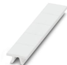
Ruban de repérage ZB, Rubans, blanc, vierge, repérable avec : PLOTMARK, CMS-P1-PLOTTER, type de montage: bloccaggio, pour bloc de jonction au pas de : 12,2 mm, Nombre d'étiquettes: 5, hauteur du champ de texte: 10,5 mm, largeur du champ de texte: 12,15 mm
