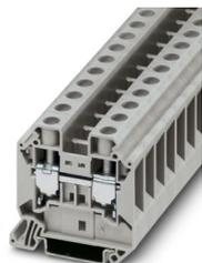
Blocs de jonction simple, tension nominale: 1000 V, intensité nominale: 76 A, nombre de connexions: 2, type de raccordement: Raccordement vissé, Section de référence: 16 mm<sup>2</sup>, section : 1,5 mm<sup>2</sup> - 25 mm<sup>2</sup>, type de montage: NS 35/7,5, NS 35/15, coloris: gris
