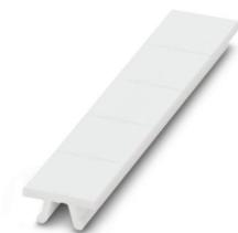
Ruban de repérage ZB, à commander : par bandes, blanc, impression selon les indications du client, type de montage: encliquetage dans la rainure de repérage élevée, pour bloc de jonction au pas de : 12,2 mm, Nombre d'étiquettes: 5
