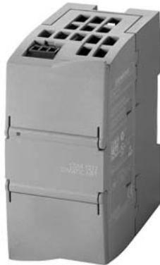
Compact Switch Module CSM 1277 pour le raccordement de SIMATIC S7-1200 et de 3 autres abonnés à Industrial Ethernet avec 10/100 Mbit/s; unmanaged Switch, 4 ports RJ45, tension d'alimentation ext. 24 V DC diagnostic LED, module S7-1200, y compris Manuel de l'appareil électronique sur CD-ROM.
