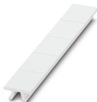
Ruban de repérage ZB, à commander : par bandes, blanc, impression selon les indications du client, type de montage: encliquetage dans la rainure de repérage élevée, pour bloc de jonction au pas de : 15,2 mm, Nombre d'étiquettes: 5
