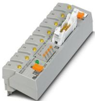
Adaptateur V8 pour 8 x embases de relais RIF-1, automate: Câblage système API des cartes de sortie, raccordement 1: Raccordement Push-in 4x, raccordement 2: IDC/FLK connecteur mâle 1x 14-pôles, raccordement 3: Raccord enfichable, nombre de canaux: 8, logique de commande: commutation positive
