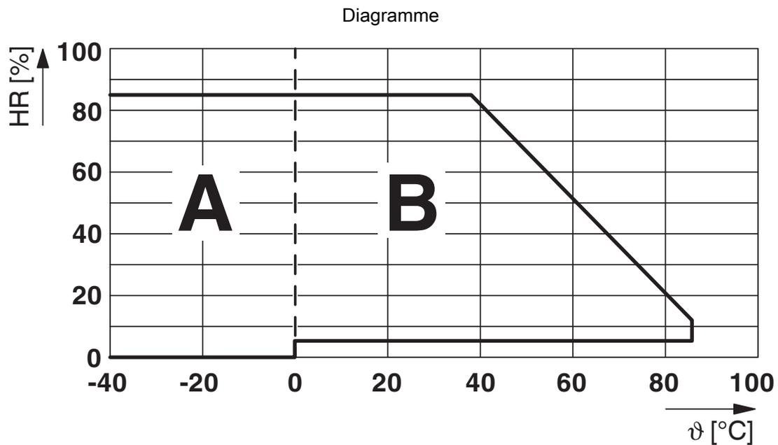
Humidité de l'air admise pour le fonctionnement et le stockage.
