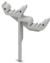
Porte-repère, encliquetable dans le bloc de jonction à ressort à deux niveaux STTB 2,5, STTB 4, PTTB 2,5, PTTB 4, repérable avec UC-TM 5, UC-TMF 5, UCT-TM 5, UCT-TMF 5, ZB 5 ou ZBF 5, gris, vierge, type de montage: enfichage, hauteur du champ de texte: 10,5 mm, largeur du champ de texte: 5 mm
