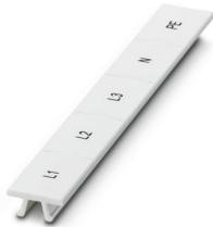
Ruban de repérage ZB, Rubans, blanc, repéré, impression longitudinale: L1, L2, L3, N, PE, type de montage: bloccaggio, pour bloc de jonction au pas de : 16,3 mm, Nombre d'étiquettes: 5, hauteur du champ de texte: 10,5 mm, largeur du champ de texte: 16,25 mm
