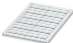
Repères pour blocs de jonction, Planche, blanc, vierge, repérable avec : TOPMARK NEO, LASER TOPMARK, BLUEMARK ID COLOR, BLUEMARK ID, BLUEMARK CLED, THERMOMARK PRIME, THERMOMARK CARD 2.0, THERMOMARK CARD, type de montage: bloccaggio, pour bloc de jonction au pas de : 16 mm, Nombre d'étiquettes: 24, hauteur du champ de texte: 4,7 mm, largeur du champ de texte: 15,2 mm
