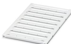
Repères pour blocs de jonction, Plaque, blanc, vierge, repérable avec : BLUEMARK ID COLOR, BLUEMARK ID, BLUEMARK CLED, PLOTMARK, CMS-P1-PLOTTER, type de montage: bloccaggio, pour bloc de jonction au pas de : 16 mm, Nombre d'étiquettes: 32, hauteur du champ de texte: 5,1 mm, largeur du champ de texte: 15,45 mm
