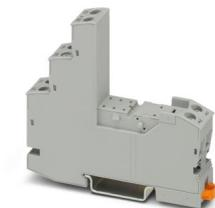
Embase de relais RIF-1..., pour relais de puissance miniatures avec 1 ou 2 contacts inverseurs ou relais à semi-conducteurs similaires, raccordement vissé, enfichabilité pour modules d'entrée/antiparasite, montage sur NS 35/7,5
