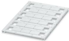
Repères pour blocs de jonction, Planche, blanc, vierge, repérable avec : TOPMARK NEO, LASER TOPMARK, BLUEMARK ID COLOR, BLUEMARK ID, BLUEMARK CLED, THERMOMARK PRIME, THERMOMARK CARD 2.0, THERMOMARK CARD, type de montage: bloccaggio, pour bloc de jonction au pas de : 16 mm, Nombre d'étiquettes: 18, hauteur du champ de texte: 9,6 mm, largeur du champ de texte: 14,8 mm
