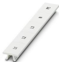
Ruban de repérage ZB, Rubans, blanc, repéré, impression longitudinale: L1, L2, L3, N, PE, type de montage: bloccaggio, pour bloc de jonction au pas de : 15,2 mm, Nombre d'étiquettes: 5, hauteur du champ de texte: 10,5 mm, largeur du champ de texte: 15,1 mm
