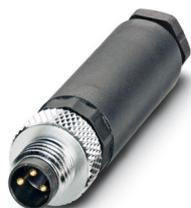
Connecteur, Universel, 3-pôles, connecteur mâle droit M8, codage: A, Raccordement vissé, matériau de la molette: Laiton, nickelé, diamètre extérieur du câble 3,5 mm ... 5 mm
