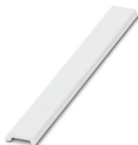
Ruban de repérage ZB, plat, Rubans, blanc, vierge, repérable avec : PLOTMARK, CMS-P1-PLOTTER, type de montage: encliqueter, pour bloc de jonction au pas de : 12 mm, Nombre d'étiquettes: 5, hauteur du champ de texte: 12,15 mm, largeur du champ de texte: 5,15 mm
