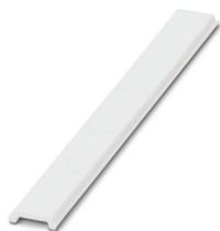
Ruban de repérage ZB, plat, à commander : par bandes, blanc, impression selon les indications du client, type de montage: encliquetage dans la rainure de repérage plate, pour bloc de jonction au pas de : 12 mm, Nombre d'étiquettes: 5, hauteur du champ de texte: 12,15 mm, largeur du champ de texte: 5,15 mm
