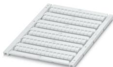
Repères pour blocs de jonction, à commander : sous forme de planche, blanc, impression selon les indications du client, type de montage: encliquetage dans la rainure de repérage plate, pour bloc de jonction au pas de : 4,2 mm, Nombre d'étiquettes: 90, hauteur du champ de texte: 4,7 mm, largeur du champ de texte: 3,4 mm
