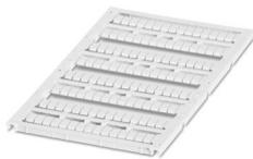
Repères pour blocs de jonction, Plaque, blanc, vierge, repérable avec : BLUEMARK E.CARD, BLUEMARK ID COLOR, BLUEMARK ID, BLUEMARK CLED, PLOTMARK, CMS-P1-PLOTTER, type de montage: encliqueter, pour bloc de jonction au pas de : 4,2 mm, Nombre d'étiquettes: 120, hauteur du champ de texte: 5,1 mm, largeur du champ de texte: 3,6 mm
