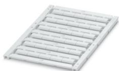
Repères pour blocs de jonction, à commander : sous forme de planche, blanc, impression selon les indications du client, type de montage: encliquetage dans la rainure de repérage plate, pour bloc de jonction au pas de : 12 mm, Nombre d'étiquettes: 30, hauteur du champ de texte: 4,7 mm, largeur du champ de texte: 11,2 mm
