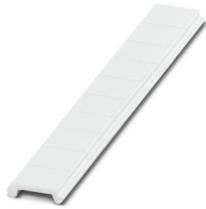
Ruban de repérage ZB, plat, à commander : par bandes, blanc, impression selon les indications du client, type de montage: encliquetage dans la rainure de repérage plate, pour bloc de jonction au pas de : 4,2 mm, Nombre d'étiquettes: 10, hauteur du champ de texte: 5,2 mm, largeur du champ de texte: 4,2 mm
