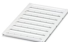
Repères pour blocs de jonction, Planche, blanc, vierge, repérable avec : BLUEMARK E.CARD, BLUEMARK ID COLOR, BLUEMARK ID, BLUEMARK CLED, PLOTMARK, CMS-P1-PLOTTER, type de montage: encliqueter, pour bloc de jonction au pas de : 12 mm, Nombre d'étiquettes: 40, hauteur du champ de texte: 5,1 mm, largeur du champ de texte: 11,45 mm
