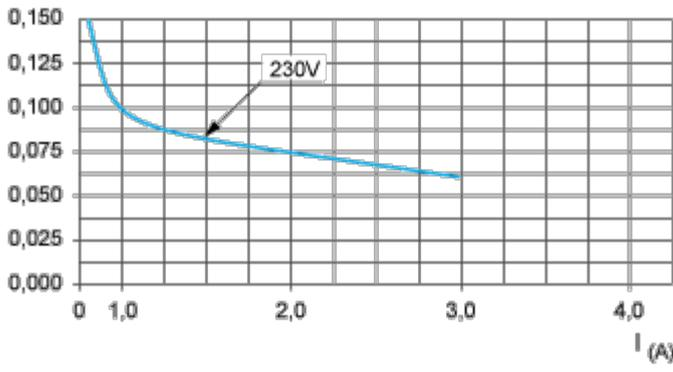
AC15 contrôle des charges électromagnétiques > 72 VA, pour établir le contact :  $\cos \phi = 0,7$ , pour le couper :  $\cos \phi = 0,4$ .
