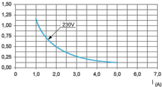
AC12 contrôle des charges résistives et des charges à état solide isolées par l'optocoupleur,  $\cos \phi \geq 0,9$ .
