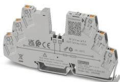
Protection électronique d'appareil mono-canal, pour récepteurs 12 - 24 V DC. Valeur fixe d'intensité nominale : 0,63 A. Avec signalisation à distance et limitation active du courant. Combinable en des blocs de jonction CLIPLINE. Pour l'installation sur des rails DIN.
