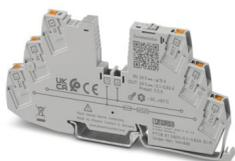
Protection électronique d'appareil mono-canal, pour récepteurs 12 - 24 V DC. Intensité nominale réglable de 0,1 à 0,63 A. Avec signalisation à distance, réinitialisation à distance et limitation active du courant. Combinable en des blocs de jonction CLIPLINE. Pour l'installation sur des rails DIN.
