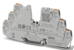
Protection électronique d'appareil mono-canal, pour récepteurs 12 - 24 V DC. Valeur fixe d'intensité nominale : 0,63 A. Avec signalisation à distance, réinitialisation à distance et limitation active du courant. Combinable en des blocs de jonction CLIPLINE. Pour l'installation sur des rails DIN.
