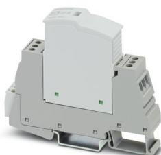
Parafoudre basse tension de type 2/3, avec fiche de protection et élément de base à raccordement vissé. Pour réseaux électriques monophasés, avec indicateur d'état intégré et signalisation à distance. Tension nominale 230 V AC/DC
