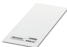
Carte de marquage, Carte, blanc, vierge, repérable avec : Crayon de marquage, type de montage: encliquetage dans la rainure de repérage élevée, encliquetage dans la rainure de repérage plate, pour bloc de jonction au pas de : 8 mm, surface utile: 6 x 8,1 mm
