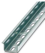
Profilé percé, Conditionnement par 25 unités (50 m), similaire à EN 60715, matériau: Acier, galvanisé, passivation blanche, Profil standard, coloris: blanc
