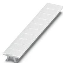
Ruban de repérage ZB, Rubans, blanc, vierge, repérable avec : PLOTMARK, CMS-P1-PLOTTER, type de montage: encliquetage, pour bloc de jonction au pas de : 6,2 mm, surface utile: 6,15 x 10,5 mm, Nombre d'étiquettes: 10
