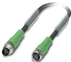
Câble pour capteurs/actionneurs, 3-pôles, PUR exempt d'halogène, gris-noir RAL 7021, connecteur mâle droit M8, détrompage: A, sur Connecteur femelle droit M8, longueur de câble: 1,5 m
