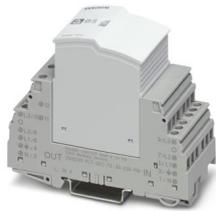
Protection d'appareil enfichable, suivant type 3 / Classe III, pour réseaux d'alimentation triphasés avec N et PE séparés (système à 5 fils : L1, L2, L3, N, PE), avec fusible résistant aux courants de choc intégré et avec contact de signalisation à distance.
